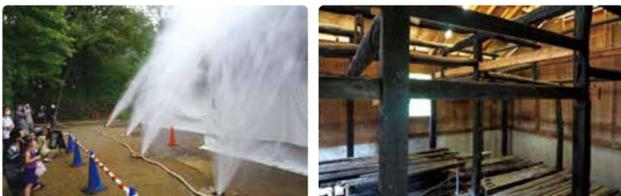
左 / 民家の破損を防ぐため、周囲をシートなどで養生して実施されたドレンチャー（延焼防止装置）放水試験。このようにドレンチャーが園内各民家の周辺地面に設置されている。右 / 1990年の火事により焼損した部材。被害が大きく復旧時に再用できなかった部材の一部を組み立てた状態で取蔵庫に保存されている（通常は非公開）。下の方に並べられている部材はさらに被害が大きく組み立てが不可能だったもの。
